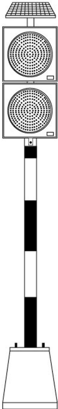
เสาเหล็กทาสีดำสลับขาว ขนาด 4" สูง 3 เมตร
